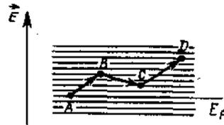
Рис. 13.7. Механизм прыжковой (перескоковой) проводимости. Ниже  $E_F$  состояния заняты электронами, выше — свободны (при  $T = 0$  К); стрелками показаны три последовательных прыжка
