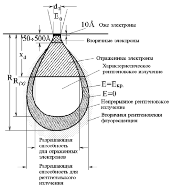
Рисунок 4. Процессы, происходящие в веществе при взаимодействии электронного зонда и материала образца.
