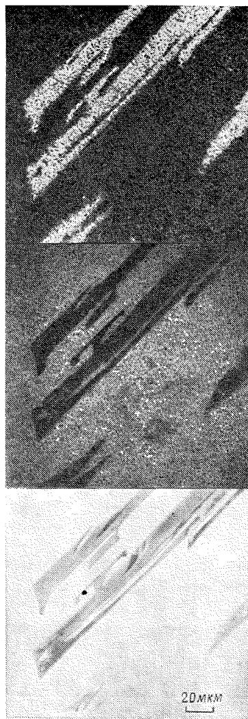
Рис. 6.16. Изображения в рентгеновском излучении при сканировании по поверхности образца из композиционного материала Al—W, полученные в РЭМ с помощью спектрометра с дисперсией по энергии.
