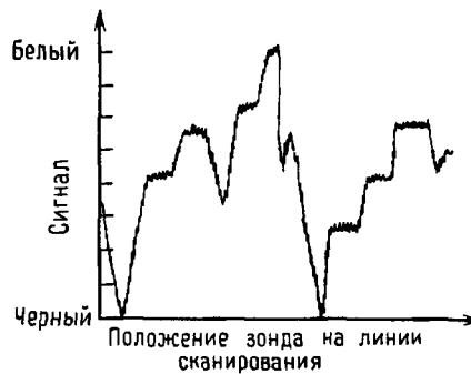
Рис. 4.42. Схематическое представление сигнала, который создавал бы «хорошее» для наблюдателя изображение: сигнал перекрывает полный динамический диапазон экрана для наблюдения.
