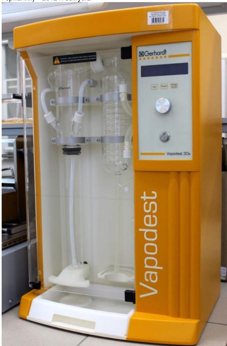
Предназначен для определения азота/протеина методом Кьельдаля.
