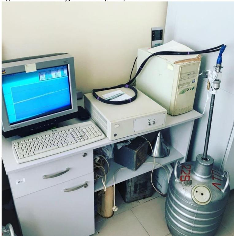
Предназначен для изучения теплоёмкости, температур и энтальпий физических превращений веществ в конденсированном состоянии, в основном полимеров, а также неорганических, металлоорганических и биологически активных соединений (например, дендримеров, фуллеренов, монодендронов, блок-сополимеров, пептидов, витаминов, гормонов).
