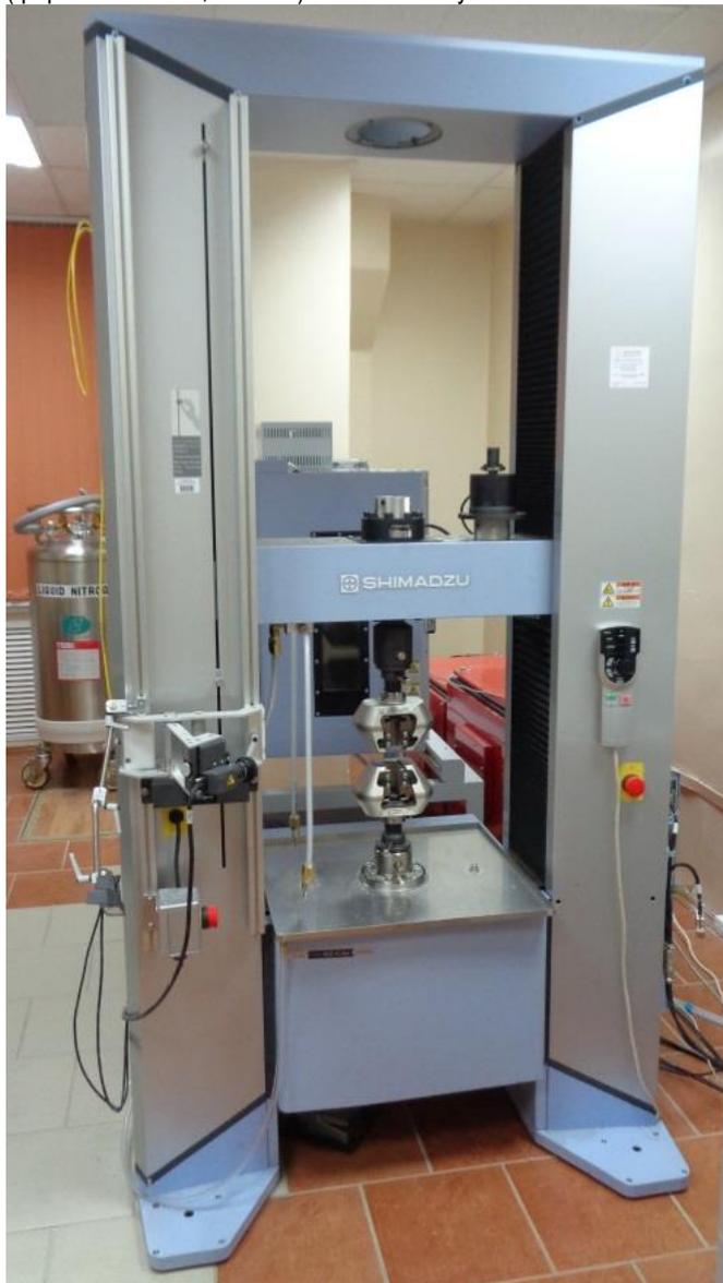
Предназначена для исследования механических свойств (растяжение, сжатие, изгиб, сдвиг и кручение) металлов, древесины, пластиков и других материалов и готовых изделий.
