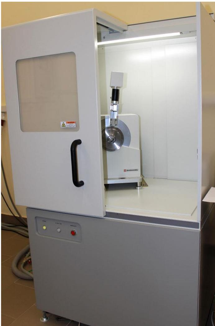
Предназначен для прецизионного определения параметров решетки, определения остаточного аустенита, расчета степени кристалличности, определения размеров кристаллитов, анализа напряжений, анализа текстур с помощью программного обеспечения Rietveld.
