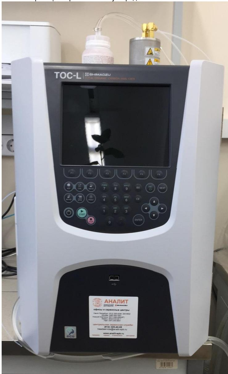
Прибор предназначен для определения общего, органического и неорганического углерода методом сжигания при 680°C и детектирования выделившегося углекислого газа по поглощению в ИК области. Производитель: Shimadzu, Япония
