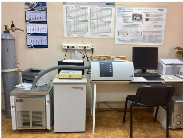
Предназначен для установления наличия термических эффектов в испытуемых материалах при помощи измерения температурной зависимости разности между тепловыми потоками образца и эталона.
