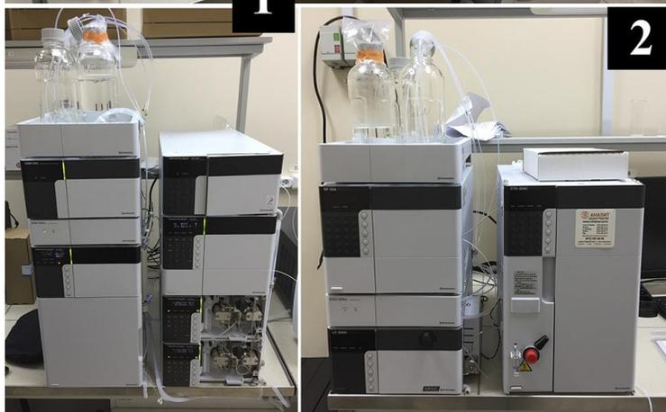
В комплекс входят: жидкостный хроматомасс-спектрометр LCMS-8050 (1), хроматограф жидкостный Prominence (2), генератор азота. Производитель: Shimadzu, Япония.
