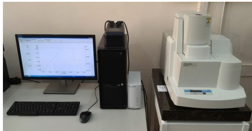
Лабораторный комплекс термо-механических испытаний материалов
