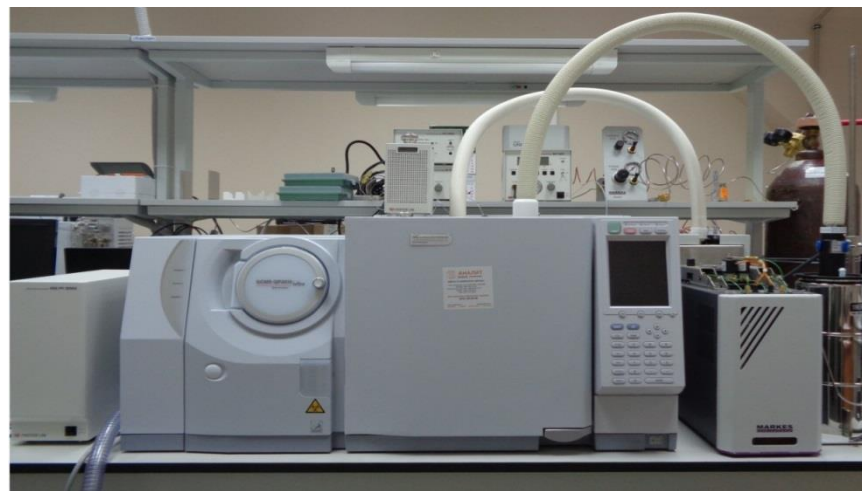
Лабораторный комплекс термического анализа материалов с идентификацией продуктов распада
