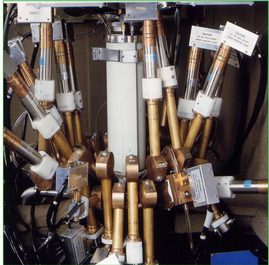
Спектрометр MXF-2400 фирмы Шимадзу (Япония); 36 кристаллов-монокроматоров
